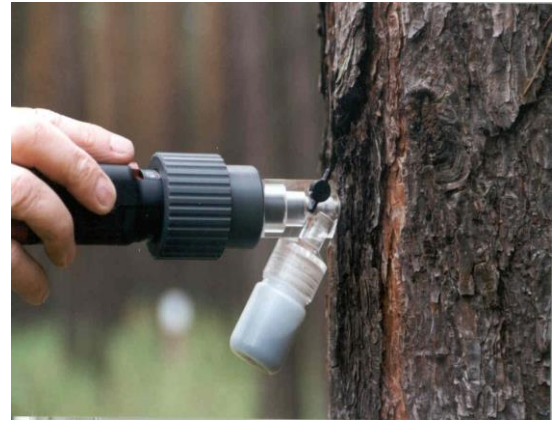
Abb.2 Entnahme von Borkenproben mit einem speziell dafür konstruierten Probenehmer in 0,5 mm Profiltiefe an der nicht von Flechten besiedelten Stammhälfte. Für repräsentative Aussagen werden maximal 25 Bäume beprobt und die Einzelproben zu einer Mischprobe vereinigt. Der Variationskoeffizient variiert abhängig von Element (Cd, Pb, Cr, usw.) oder Verbindung (SO 4 S, NH 4 N, g-HCH, Benzo(a)pyren) zwischen 8.5 bis 13.4 % (SCHULZ et al. 2001).
